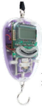
可打印透明的功能组件及外壳，方便观察内部的组装运作
